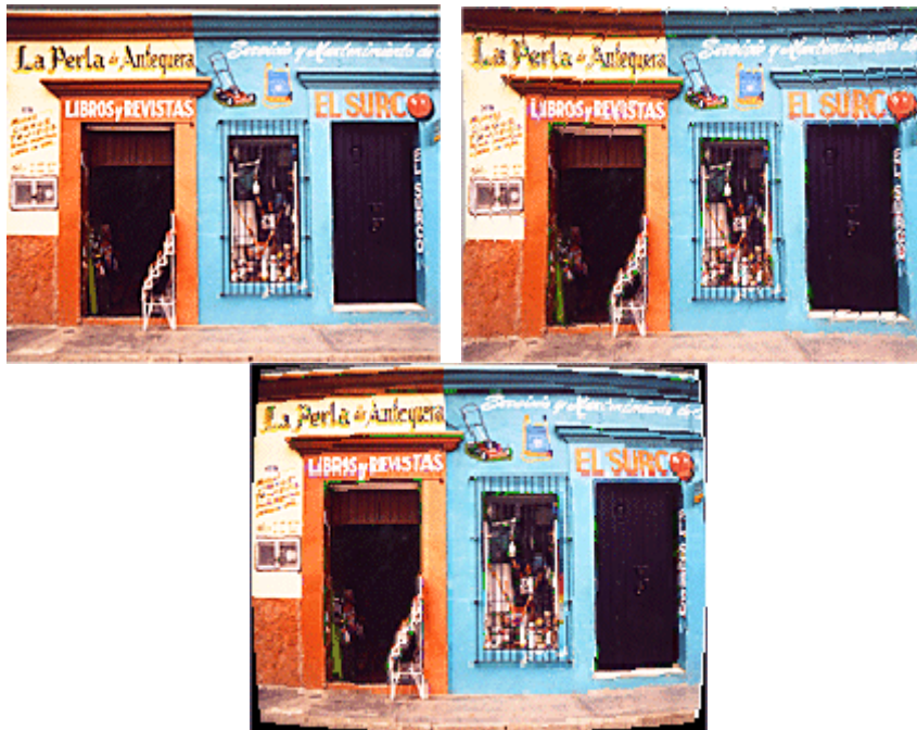
Abb.: 5 Verzeichnungen für ein reales Objekt. Von links nach rechts: Originalbild, 10% kissenförmige, 10% tonnenförmige Verzeichnung
