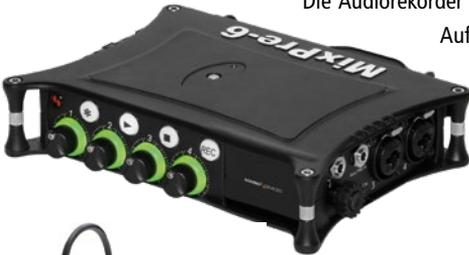
Die Audiorekorder der Sound Devices Mixpre II Serie waren unter den ersten tragbaren Aufnahmegeräte, die mit der aus der Studioteknik bekannten 32-bit-Floating-Point-Methode arbeiteten und dem Anwender einen extrem großen Dynamik-Bereich für den On-Location-Ton bieten. Damit ist ein Übersteuern des Aufnahmesignals praktisch nicht mehr möglich. Gleichzeitig können die Geräte auch als USB-Audiointerface für Streaming genutzt werden.
